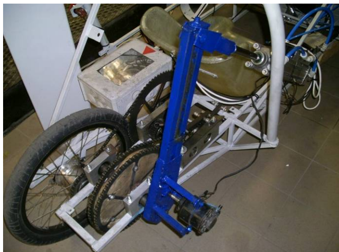
7. ábra: Ingás hajtáslánc kivitelezése (Piukovics, 2013)
